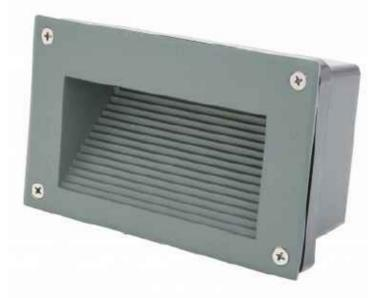
M4 - Aplique para empotrar con led cob 3W 162x98x64 mm. IP65. A 30cm. del suelo. Conectada a batería para suministro autónomo 24V DC
