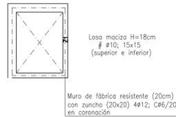
Muro de fábrica resistente (20cm) con zuncho (20x20) 4#12; C#6/20 en coronación
